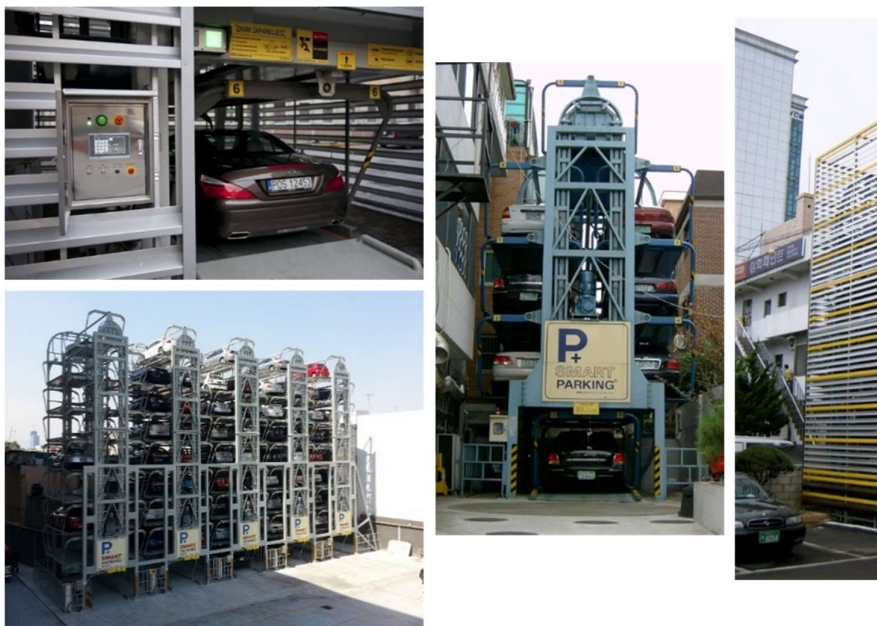
3-8. ábra. Példák a rotációs parkolóház alkalmazására Forrás: http://smartparking-systems.com/
